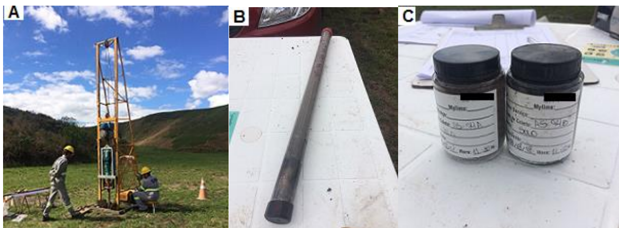
Figura 1 - A: Trado mecanizado utilizado para perfuração das sondagens investigativas. B: Amostrador do tipo liner descartável utilizado para obtenção de amostras de solo. C: Amostras de solo acondicionadas em frascos de vidro para transporte ao laboratório.
